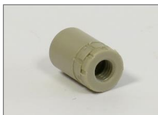
Porte-échantillon Surface active : Ø6 mm
